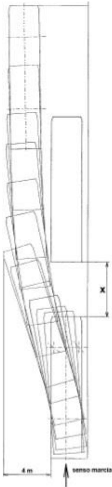
Deve essere fornita la distanza minima **X** tra i due veicoli che permette il superamento del veicolo fermo considerando uno spostamento di **4 m** rispetto al filo laterale sinistro del veicolo da superare.
